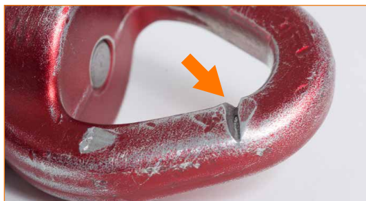
Corps présentant une entaille supérieure à 1 mm à proximité du point d'attache.
